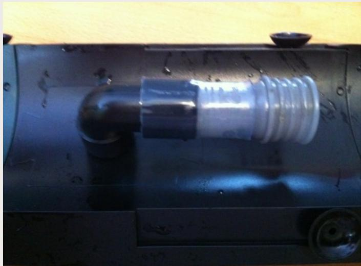
Fertig montiert und im Aquarium versenkt, verrichtet der OFA seinen Dienst Anstandslos und vor allem Geräuschlos. Ich vermute das durch die Größe und Gewicht des Schwimmers, sowie durch sein gebogenen Form, das Oberflächenwasser relativ lautlos einfließen kann.
