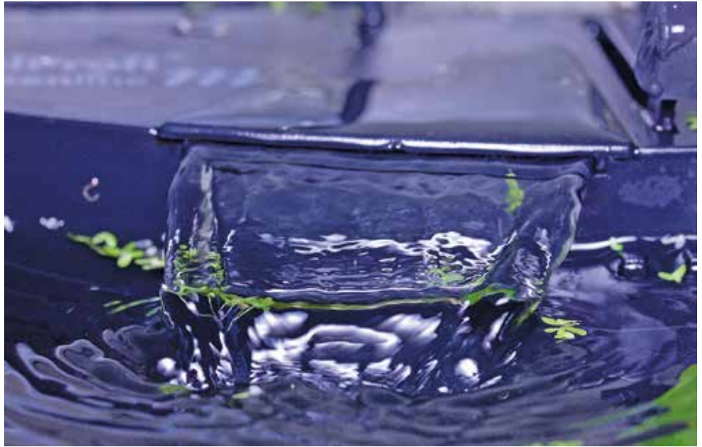
Der Filterauslauf ist kräftig und leise. Die Bewegung der Oberfläche lässt sich durch die Höhe des Wasserstands prima regulieren.
