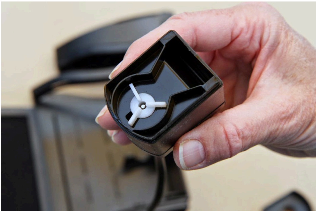
Foto RE der Propeller sitzt unten in der Pumpe
