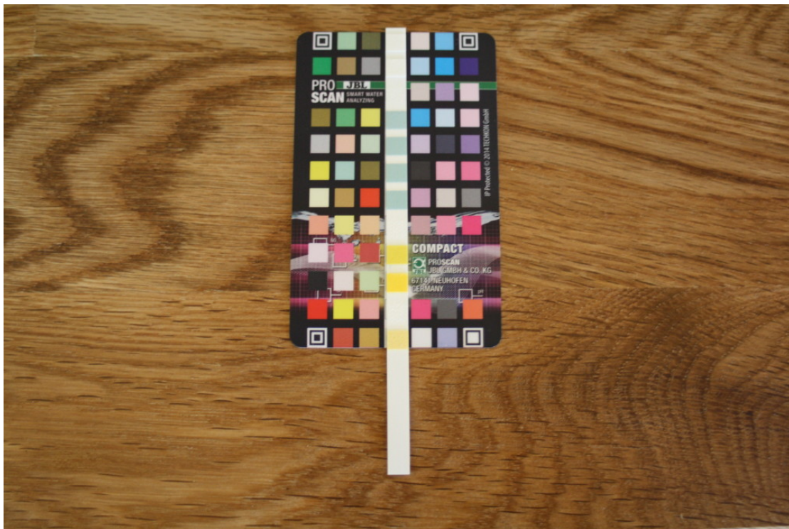
Der Teststreifen des JBL ProScan wird mittig auf der Color Card positioniert.
