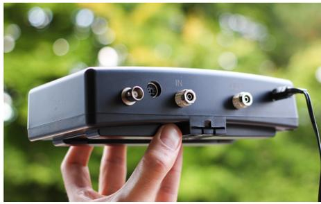
Der pH Control steuert über die Messung des aktuellen pH Wertes im Aquarium, die programmierte (und zuvor gemessene) Karbonathärte des Wassers und ein eingebautes Magnetventil (das den CO2 Strom unterbricht), die Menge an CO2 die dem Becken zugeführt werden muss um einen bestimmten pH Wert zu erreichen.
