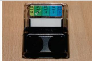
Gefüllt wird der durchsichtige Kunststoffbehälter mit 35 Tropfen der Indikatorflüssigkeit.
